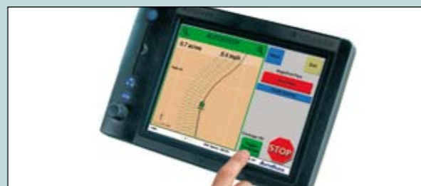
Monitoren er stor og med en farveskærm, der har dansk tekst i alle menuer. Den betjenes ved berøring med en fingerspids – og den giver sammen med den indbyggede computer et væld af muligheder.
