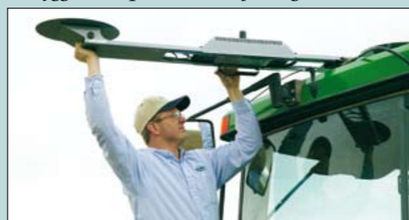
Sådan er tagmodulet med den dobbelte antenne monteret på taget. Den er ikke særlig tung samtidig med, at den er nem at sætte på og tage af igen. Derfor kan den også flyttes mellem køretøjer, hvis man ikke ønsker at køre med AutoFarm på flere køretøjer samtidig.
