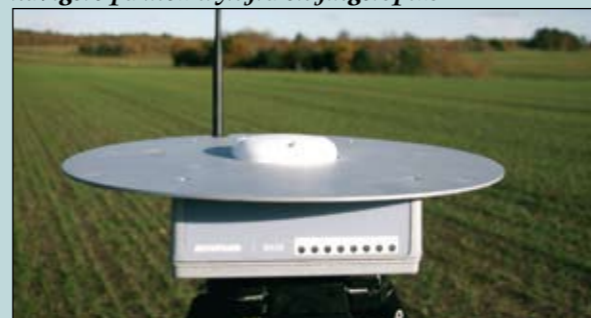
Sådan ser basisstationen ud til AutoFarm. Den skal stilles op inden for en afstand af højst 10 kilometer, når man vil køre med 2 centimeters nøjagtighed. I stedet for den kan man bruge en mobilenhed. Systemet kan også køre med 10 centimeters nøjagtighed uden basisstation eller uden mobilenhed.
