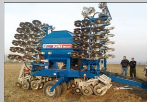
Juri såmaskinen kan klappes sammen, så den har en transportbredde på 3,0 meter.
