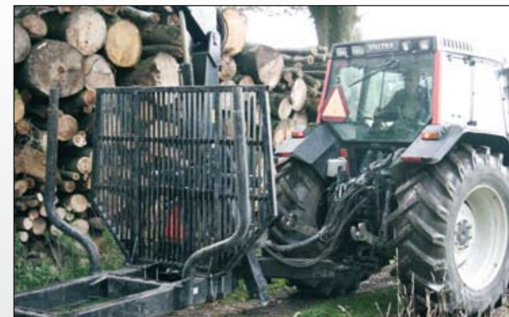
Læg mærke til, hvordan vognen er skudt til siden. Så kan den følge i traktorens spor og bedre manøvreres i skoven, hvor pladsen er trang.
