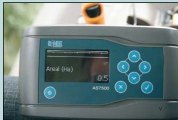
Betjeningsenheden til Rinex sprøjtecomputeren. Den monteres i forbindelse med sprøjtecomputeren, som den skal kobles op på.
